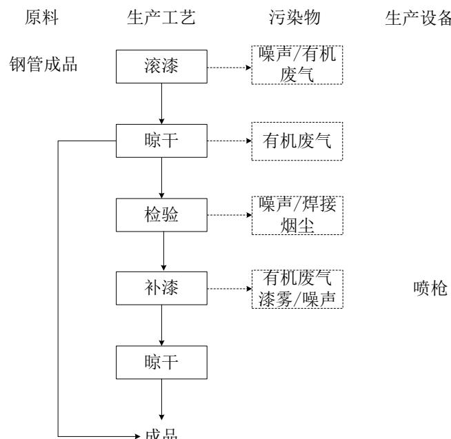
图 2-2 项目滚漆生产工艺流程及产污环节示意图
