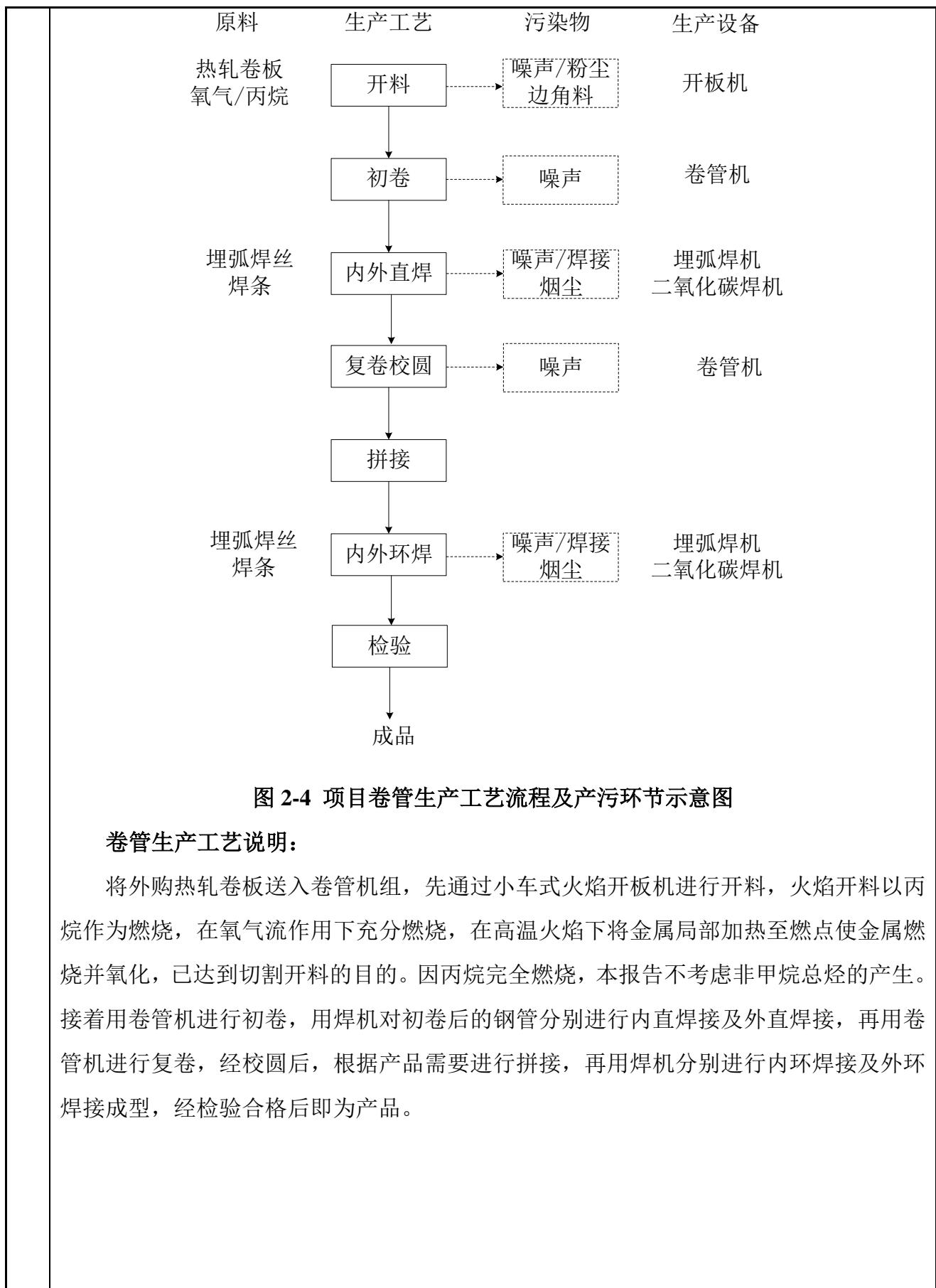
图 2-4 项目卷管生产工艺流程及产污环节示意图
