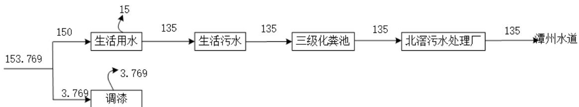
图2-2 项目扩建后水平衡图 (单位: t/a)
