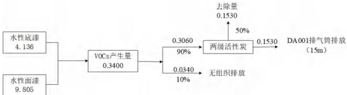
图2-1 项目扩建后VOCs平衡图 (单位: t/a)
