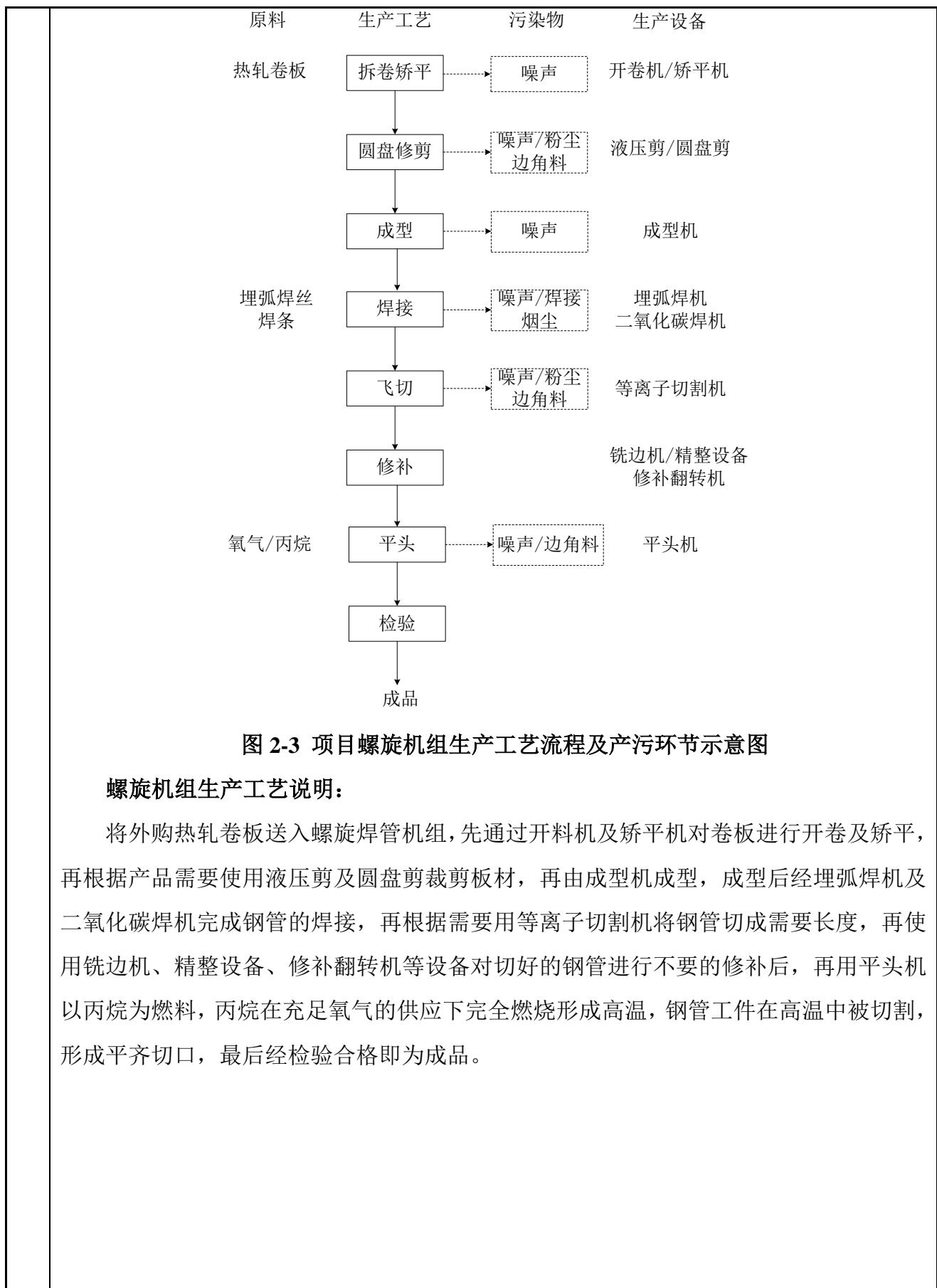
图 2-3 项目螺旋机组生产工艺流程及产污环节示意图
